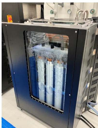
図 1: Opteon™ 2P50 と二相液浸タンク
